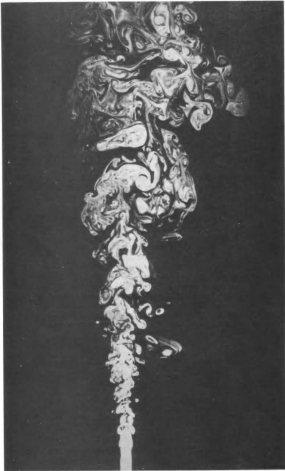
Fig. 3.9 Visualisation of a jet flow
